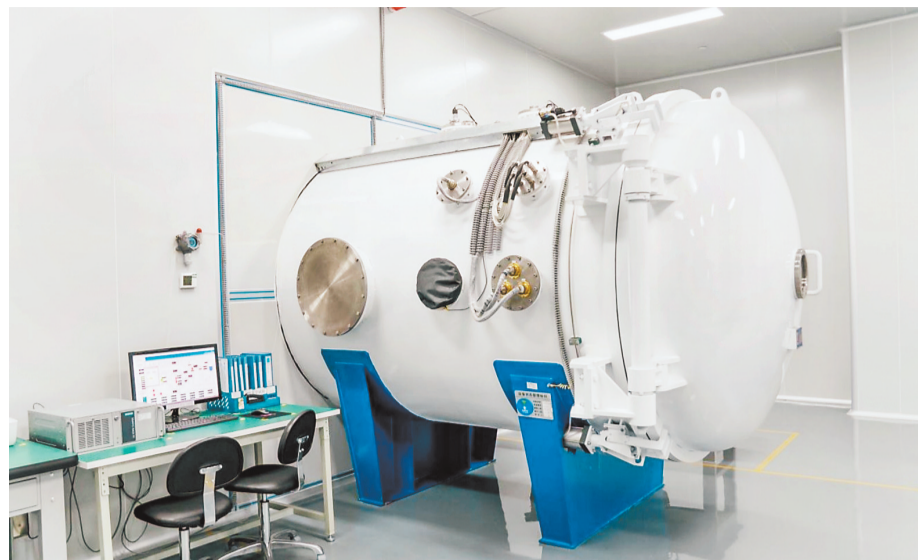
开拓卫星用于做热真空试验的设备。
