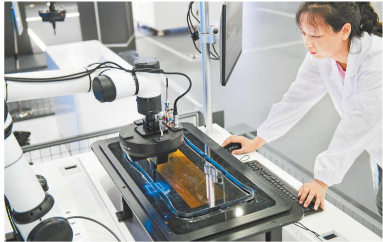
涂胶检测系统。四月三日，中科摇橹船研发人员正在调试该设备。
