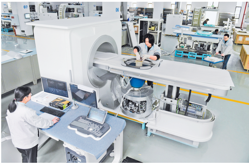
3月22日，重庆海扶医疗科技股份有限公司，质量部出厂检验人员正用牛肝对海扶刀®聚焦超声肿瘤治疗系统进行出厂检验。 记者 张锦辉 摄/视觉重庆
