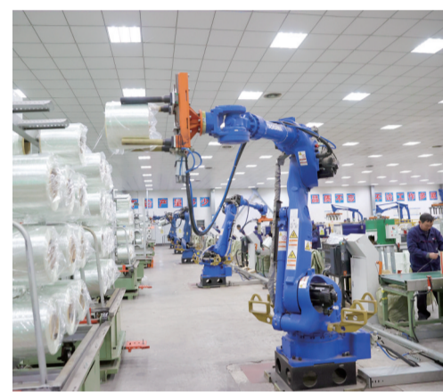
在黔江区工业园区三磊玻纤公司生产车间,工业机器人在搬运玻纤产品。摄/杨敏
