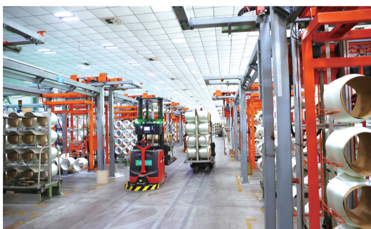
三磊玻纤有限公司络纱车间,机器人在转运玻纤产品
