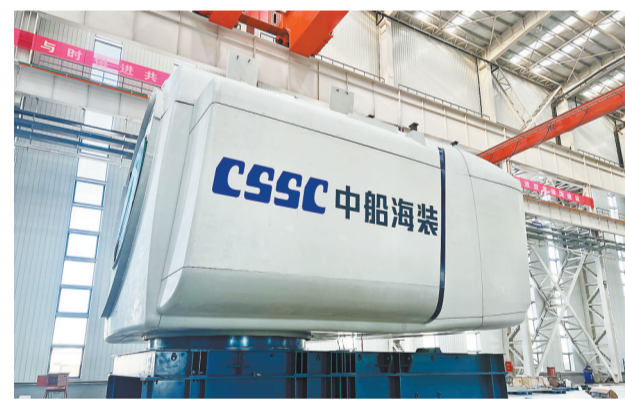
全球首款18兆瓦级集成式中速海上风电机组
