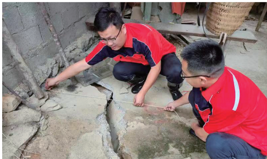
驻守地质工程师陈志荣(左)在监测陡崖子滑坡裂缝变形情况
