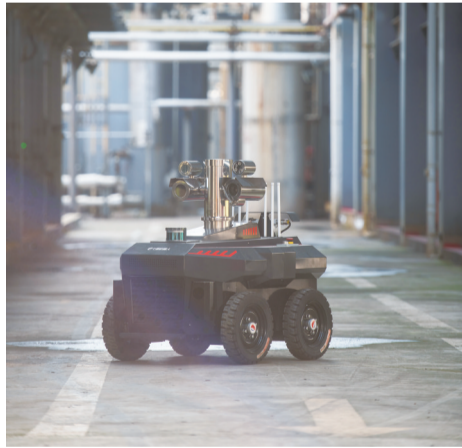
智能机器人现场巡检
