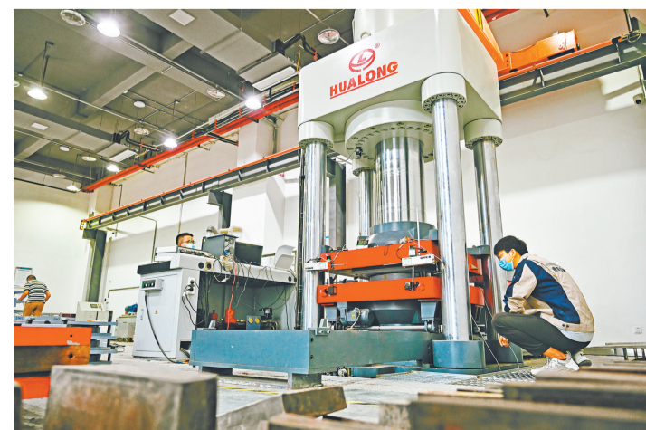
9月8日,工作人员在进行桥梁支座试验。
