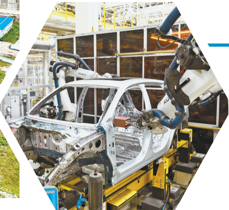
领克汽车成都工厂焊装车间，机器人臂正在对车身关键测点进行检测。 记者 张锦辉 摄/视觉重庆
