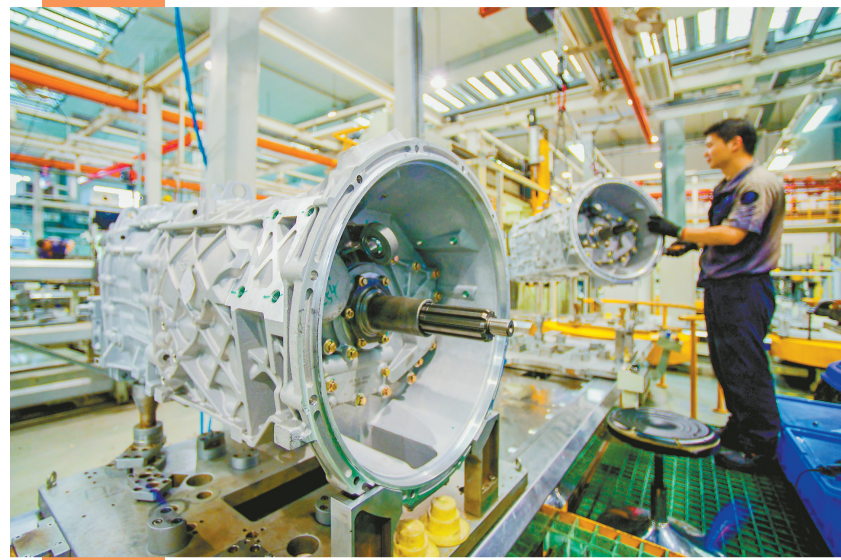
▲ 綦江齿轮传动有限公司生产车间内,工作人员正在对S变速器质检。 该企业积极转型升级,研发出多款混合动力及纯电动客车、卡车用变速器,与多个知名客车、重型车品牌建立了良好合作关系。(摄于6月3日) 特约摄影 陈星宇/视觉重庆
