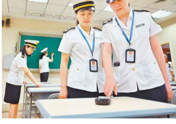
6月2日，位于沙坪坝区的重庆一中本部，市卫生健康委执法总队工作人员正在测量教室内课桌面的平均照度。
