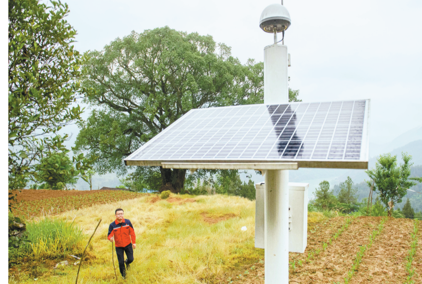
在陡磊子滑坡变形区内查看GNSS地表位移监测设备运行情况。五月九日，武隆区江口镇黄草村，驻守地质工程师正在监测滑坡变形区地表位移监测设备运行情况。记者 张锦辉 摄/视觉重庆
