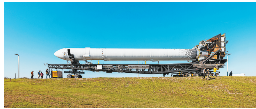
3月7日,在美国佛罗里达州卡纳维拉尔角太空军基地拍摄的“人族一号”火箭。被美方称为全球首枚高占比3D打印制造而成的美国相对航天公司研制的“人族一号”火箭,11日在美国东南部发射失败。该火箭高33.5米,直径2.2米,85%由3D打印而成,包括发动机,相对航天公司称,火箭60天就可造好。 新华社发
