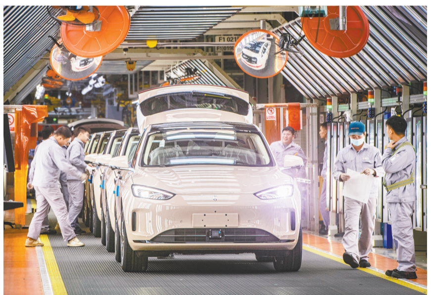
位于两江新区鱼复新城的赛力斯汽车两江智慧工厂总装车间,工作人员在最终线对新能源汽车进行外观、内饰等检查。(摄于10月29日)
