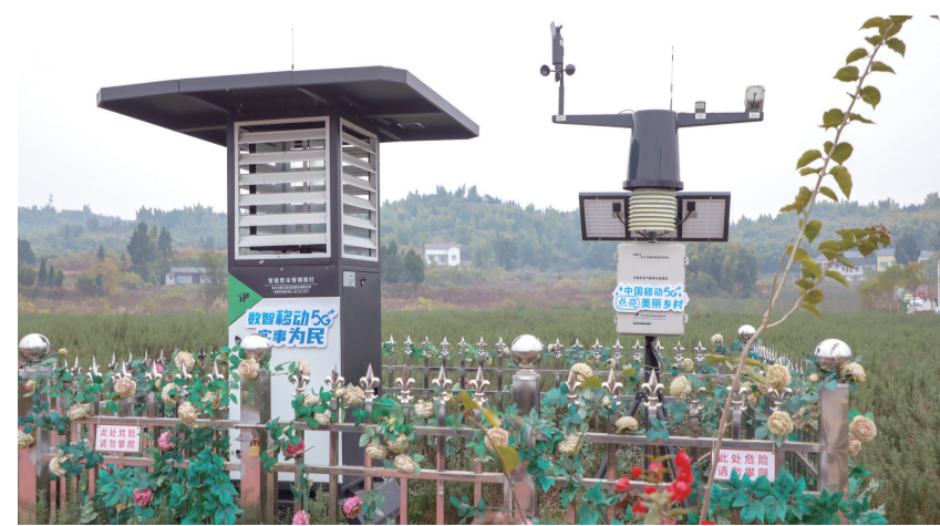
重庆移动在大足芳香产业园布设的5G+农业气象综合监测站和智能虫情监测报系统
