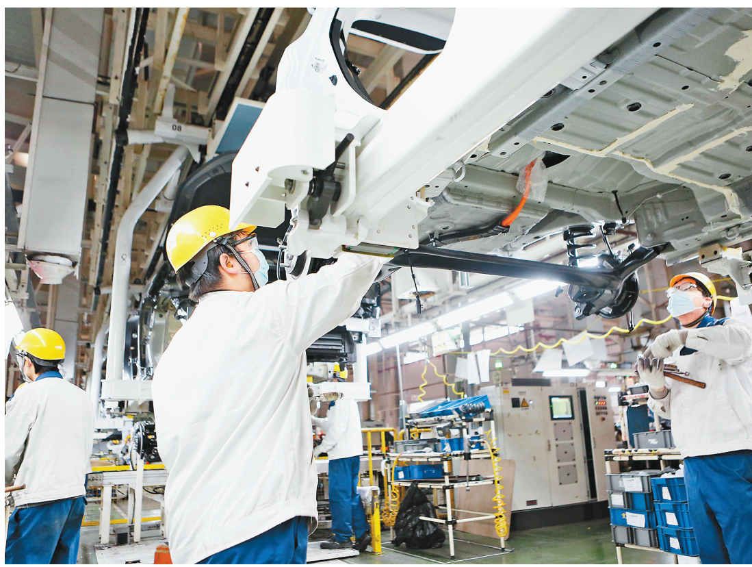
▲12月8日，巴南区大江科创城，重庆铃耀汽车有限公司生产车间，工人对车辆进行底盘装配作业。目前，该企业约3000名工人已返岗，各个生产环节井然有序，确保满足市场需求。
