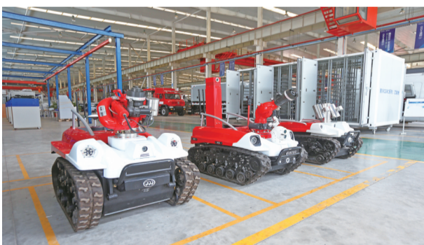
迪马工业消防机器人具备耐高温、防爆、定位导航、模块化、自编降温等技术优势
