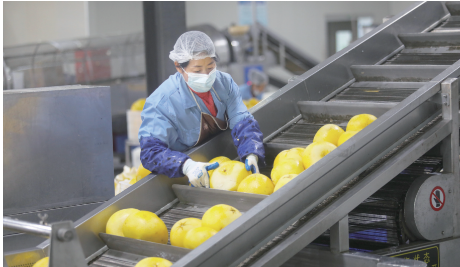
梁平区奇爽食品有限公司的智能化柚子清洗机 摄/刘辉
