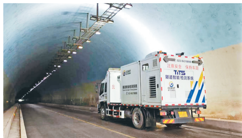
今年七月,隧道检测车在开州区开展隧道定期检测。(受访者供图)
