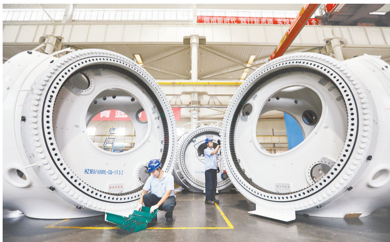
8月31日,海装风电总装车间,技术工人正忙着进行风电机组的装配工作。
