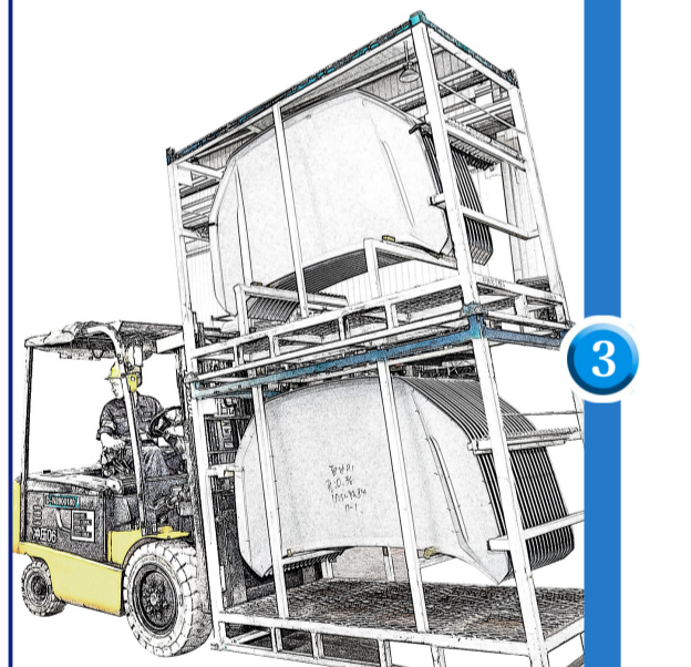
▲8月10日，冲压车间的工人正在运输冲压成型的引擎盖板。
