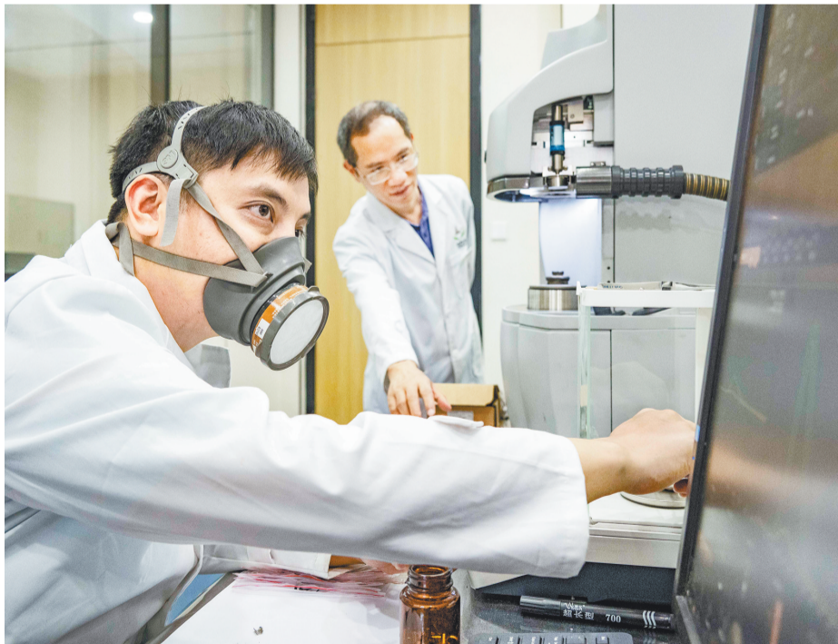
七月二十五日，在位于江北区港城工业园的重庆润际远东新材料科技股份有限公司，实验检测人员运用氧氮分析仪测定合金元素含量。
