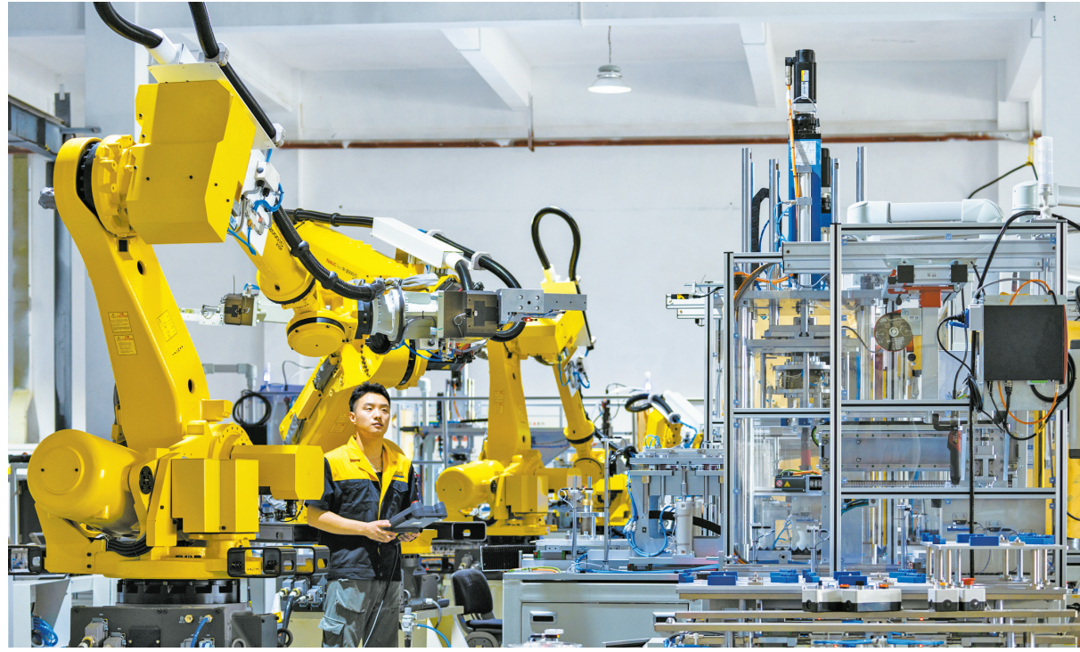
福伦德实业新能源汽车发电机智能生产线,机器人自动抓取实现整线自动装配
