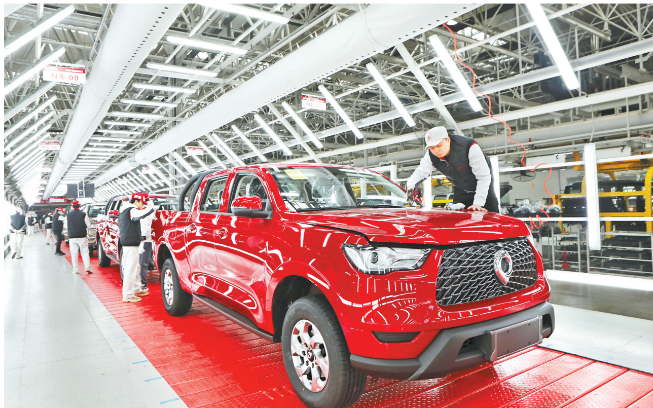
永川区长城汽车股份有限公司技术人员在总装车间对“长城炮”皮卡进行检验。(摄于2022年2月6日)
