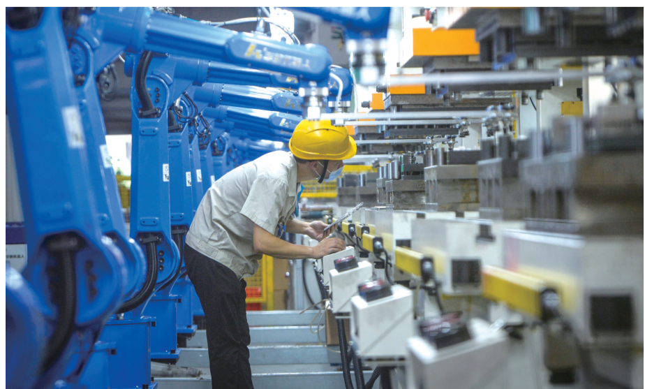
东矩金属笔记本外壳自动化冲压生产线
