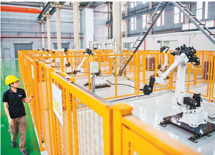
在重庆华数车间,研发人员正在对工业机器人进行连续运行测试。 记者 张锦辉 摄/视觉重庆
