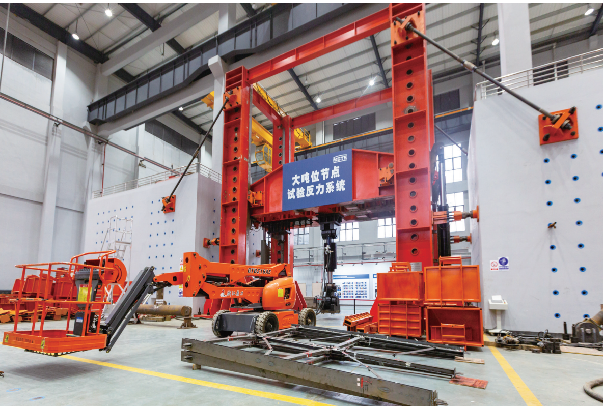
重庆交通大学山区桥梁及隧道国家重点实验室大吨位节点试验反力系统
