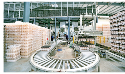
重庆华绿生物有限公司装瓶车间，自动化生产线有序传送运输食用菌瓶 摄/王泸州
