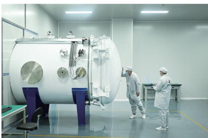
开拓卫星试验工程师在对卫星电源产品进行热真空实验
