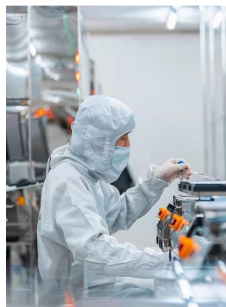
天实精工研发人员进行摄像头模组前段封孔点胶
