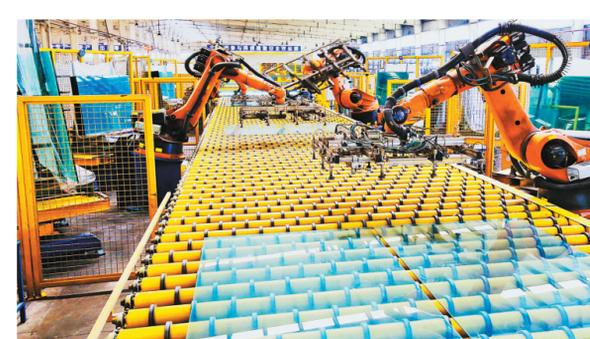
浮法玻璃自动化生产线上，一片片高档汽车玻璃不断下线(资料图片)
