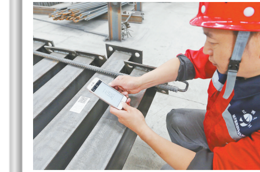
▲T梁贴有二维码，工人可扫码了解部件的详情情况。
