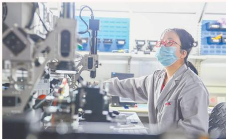
2021年5月11日,重庆高新区联合微电子中心,技术人员在硅基光子实验室测试硅光芯片。
