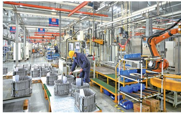
綦江传动自动装配生产线检验人员检验变速器壳体
