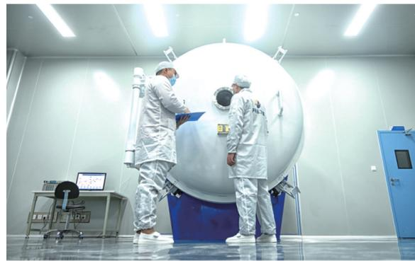
重庆开拓卫星科技有限公司工作人员正在进行太阳能电池阵热真空实验
