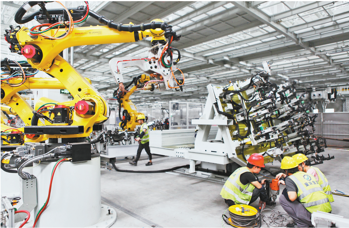
九月十四日，位于永川高新区凤凰湖产业园的长城汽车永川工厂，工程技术人员在长城坦克300线体上安装、调试机器人。 特约摄影 陈仕川/视觉重庆
