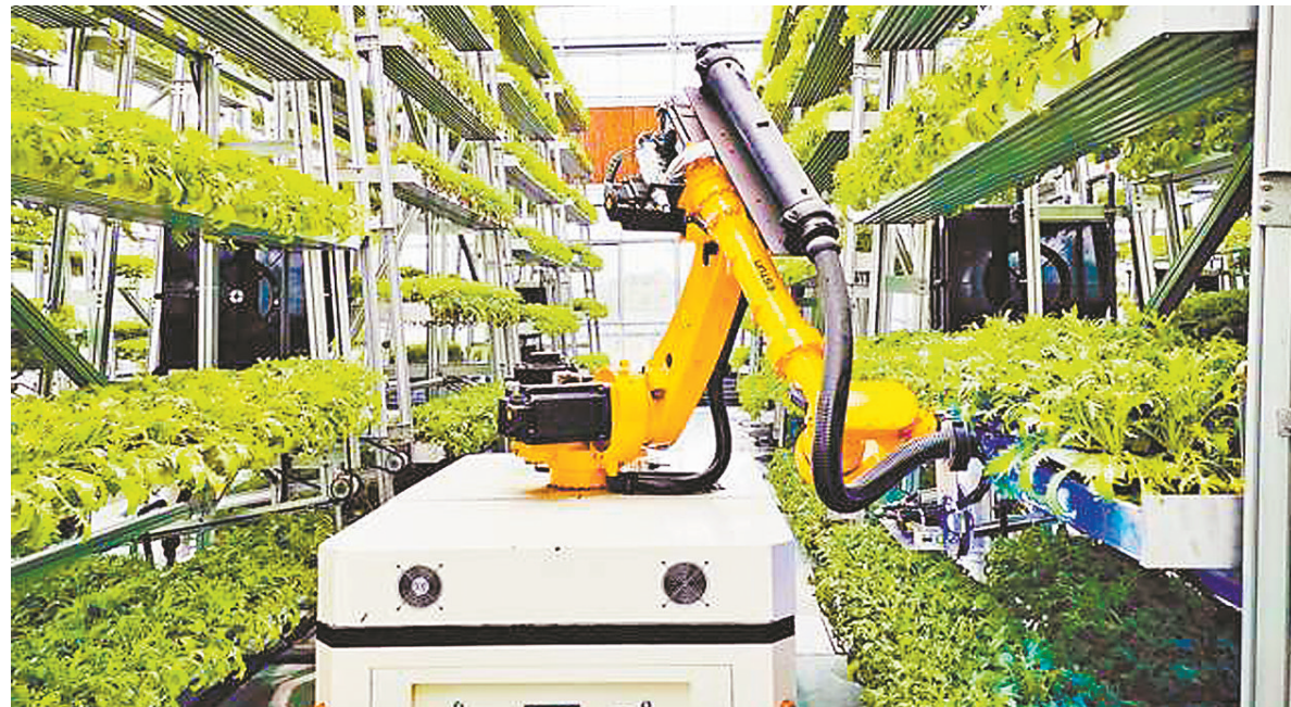
『叶菜工厂』内可移动机器人正在收割叶菜。(重庆市农业科学院供图)
