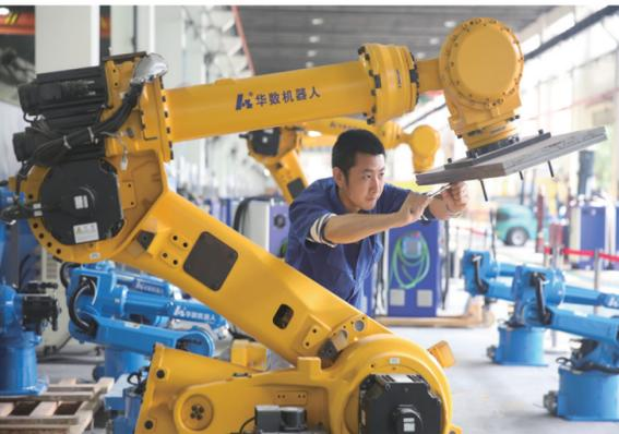
重庆华数机器人有限公司调试工程师在为即将出厂的工业机器人进行载重性能测试 摄/秦廷富
