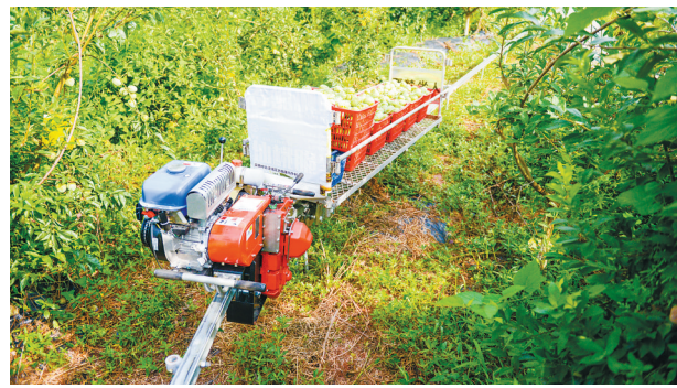
古路镇乌牛村仙桃李。山地单轨运输机像小火车一样在一条蜿蜒曲折的轨道上行走,将成熟的仙桃李运送到山下,山地上下既轻松又快捷。
