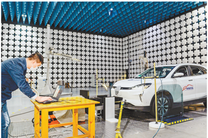
中国汽车工程研究院股份有限公司检测中心EMC试验室，工作人员正在对智能网联车的网联性能进行非道路测试评价。
