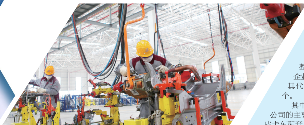
技术人员在机仓岗位上焊接左右轮罩 摄/陈仕川
