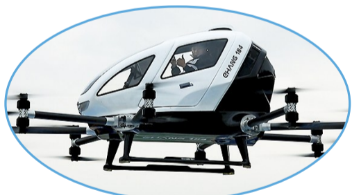
亿航自动驾驶飞行器进行载人飞行测试。
