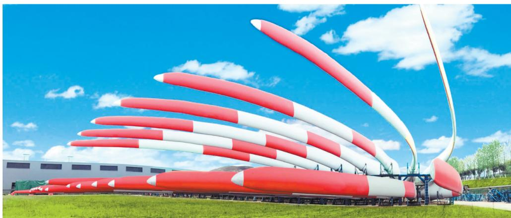
超大型玻璃纤维风电叶片。
