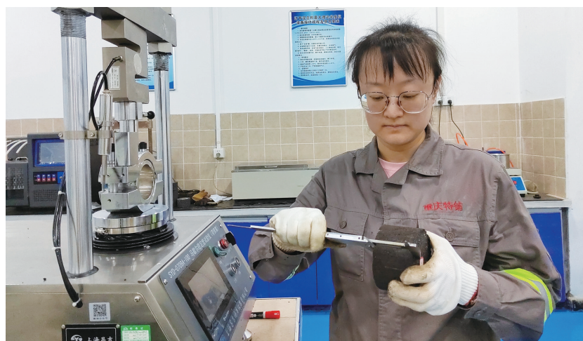
张焯在测试试件的抗弯拉性能
